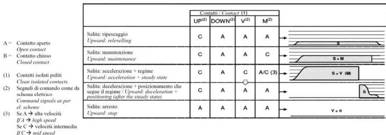
Il comando V ed M non hanno alcun effetto se dati senza il comando Up. Il comando Up da solo attiva il ripescaggio e il movimento della cabina in salita alla velocità di posizionamento. Affinché il comando sia interpretato dal MED come corsa a velocità piena, intermedia o di manutenzione, è necessario che V e M siano dati prima o entro 500 ms dall'arrivo di Up. Segnali successivi a tale tempo verranno ignorati dal MED.
